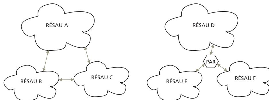
Il y a homologage entre chacun de ces trois réseaux, directement ou par un point d'échange internet (IX) ou un point d'accès au réseau (PAR).
